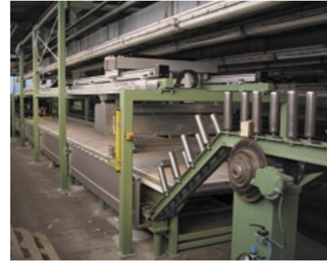
Aufbau und Integration eines 15 m langen XYZ-Positioniersystems mit Maschinengestell in eine Produktionslinie.
