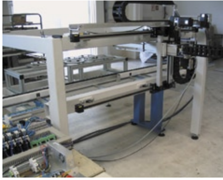
Montage und Inbetriebnahme einer Handlingmaschine zum Umsetzen von Bauteilen von einem Förderband in ein Prüfsystem innerhalb einer Fertigungslinie
